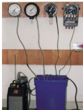
图2 18m-温度计环境温度试验
